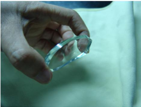
❶ 반드시 건식과 습식을 같이 하여 광을 내어야 합니다. 건식만 할 경우에는 렌즈에 마찰열이 발생하고 표면에 충분한 광을 낼 수 없습니다. 옥습기내에 광내기휠이 장착되어 있고 습식으로 광을 내면 가장 짧은 시간에 가장 좋은 표면 품질을 얻을 수 있습니다.
